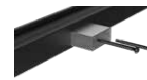
Verbindungsteil mit Schraube 5 x 70 mm an die Unterkonstruktion befestigen, 209314
