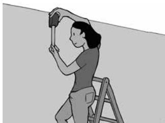
II. Verwenden Sie eine lange Wasserwaage (ggf. in Kombination mit einer Richtlatte) und zeichnen Sie eine horizontale Referenzlinie über die gesamte Wandbreite.
