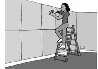
d) Gestrichene oder grundierte Wände müssen vor der Montage vollständig getrocknet/ausgehärtet sein und angeschliffen werden (Körnung 80).
