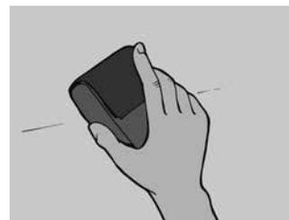
d) Les murs peints ou pourvus d'un apprêt doivent être totalement secs et être poncés (grain de 80) avant le montage.
