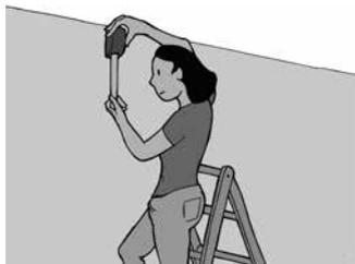
II. Utilisez un long niveau à bulle (le cas échéant avec une règle de maçon) et dessinez une ligne de référence horizontale sur toute la largeur du mur.
